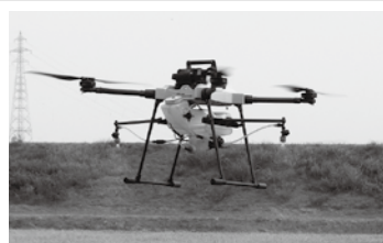
▲搭載したタンクの両脇のノズルから薬剤を散布します
